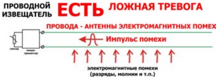
Рис.2. Воздействие электромагнитных помех на проводные извещатели.
