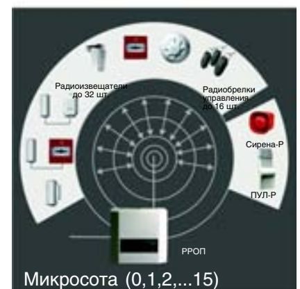
Рис. 9. Структурная схема радиосистемы «Стрелец»
