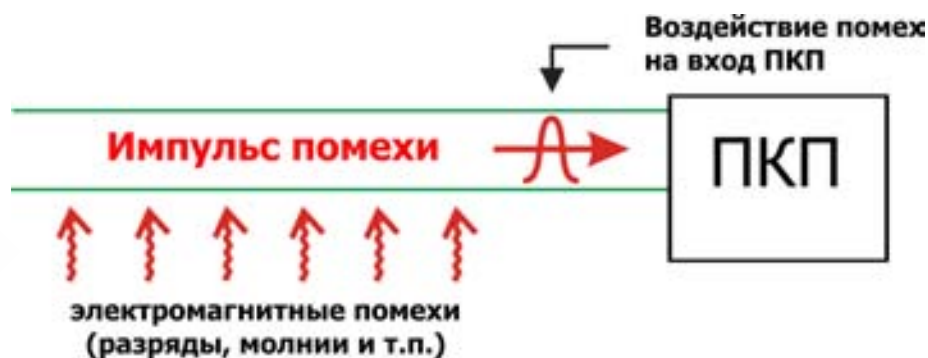
Рис.1. Воздействие электромагнитных помех на проводные приемно-контрольные приборы.
