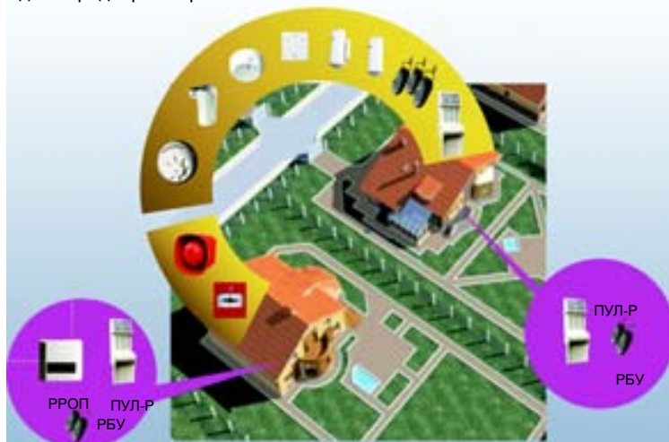
Охрана нескольких соседних коттеджей с использованием одного радиорасширителя
