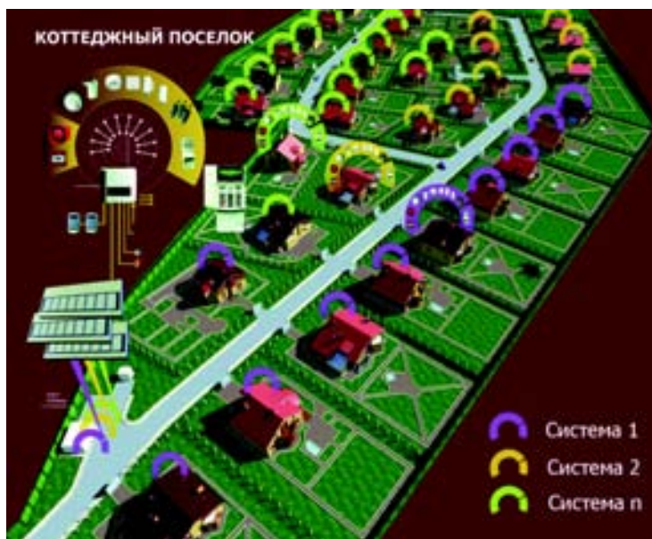
ОПС коттеджного поселка на базе радиосистемы СТРЕЛЕЦ®
