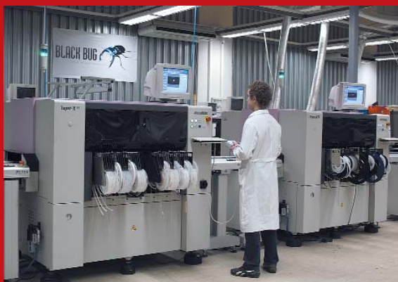
Высокоточные автоматы TORAZ-X II позволяют быстро и точно устанавливать все типы электронных компонентов
