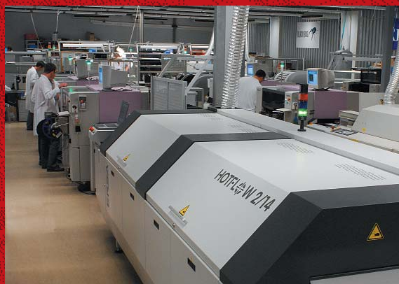
Пайка установленных компонентов производится в конвейерных конвекционных печах ERSA Hotflow
