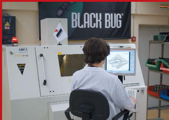
Для проверки качества изделий применяются системы автоматической оптической инспекции и рентгеновского контроля
